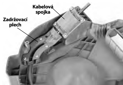
Obrázek 18 – Sundaný horní kryt čističe odpadů
