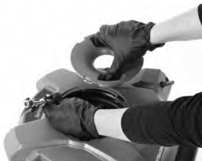
Obrázek 7B – Vytáhněte řetězový omítací nástroj / kabel
