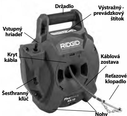
Obrázok 1A – Čistička odtokov RIDGID® K9-12 FlexShaft
