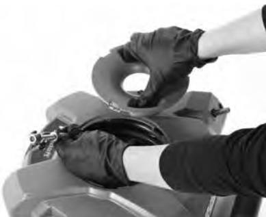
Obrázok 7B – Vytiahnutie reťazového klopädla/kábla
