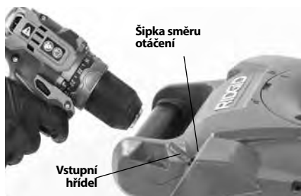
Obrázek 4 – Připojení vrtačky k vstupní hřídeli
