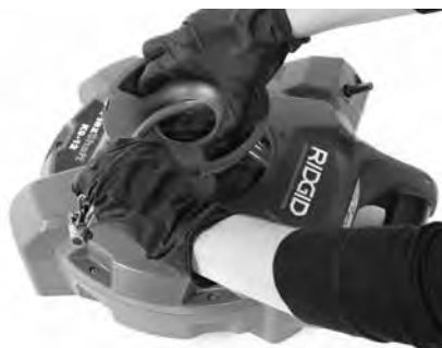
Obrázek 7C – Kabel protáhněte otvorem ve víčku kabelu
