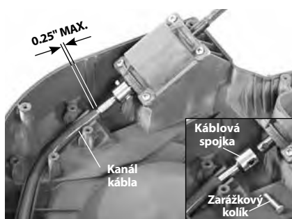
Obrázok 19 – Montáž náhradného kábla
