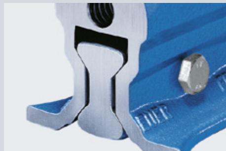
Schraubstock bietet. Die bearbeiteten, gesenkgeschmiedeten Führungslaschen halten die Führungsschiene mit doppelter innenliegender Prismenführung genau auf Kurs. Ohne unangenehmes Wackeln oder Hakeln.
