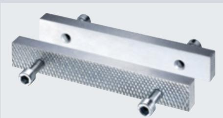
Die auswechselbaren Backen können beidseitig verwendet werden. Sie besitzen eine geriffelte und eine glatte Seite und werden durch je zwei Innensechskant-Schrauben gehalten.
