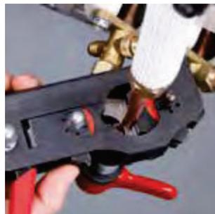
Automatischer Tiefenanschlag: Perfekte Positionierung des Rohres zum Bördelkonus
